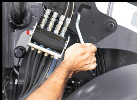
**3** A alavanca de bloqueio é pressionada para baixo e o carregador frontal é fixado em segurança na amarração. Depois, levanta-se o carregador frontal mais um pouco.
