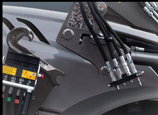
**1** Ao engatar, o carregador frontal desliza na amarração, até que os pernos tensores toquem na extremidade superior da calha deslizante.
